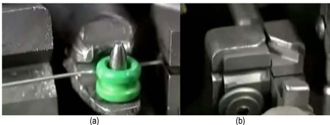
Figura 4 – Processo de colocação das ponteiras (a) início; (b) corda e ponteira já ejetadas (Stagliano, 2013).
