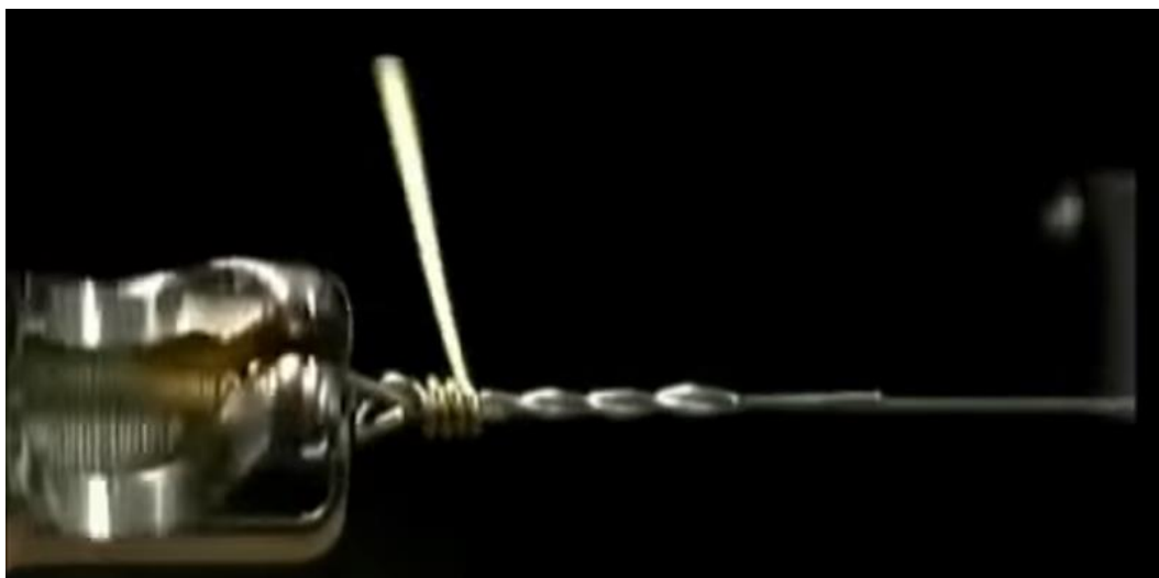
Figura 5 – Processo de enrolamento do fio de bronze na alma (Stagliano, 2013).
