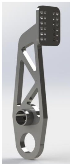
Figura 8 – Renderização do projeto final do pedal de freio do protótipo GXE01.
