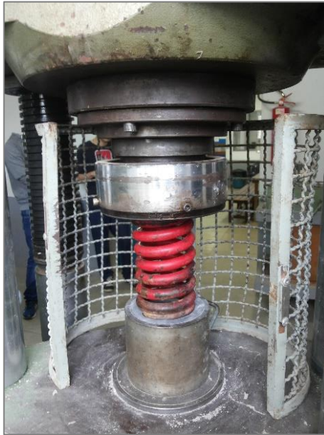
Fig. A-1 – Ensaio de compressão da mola.
