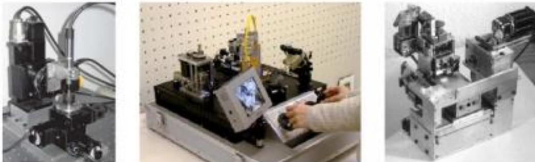
Figura 10 – Micromáquina-ferramentas para aplicações diversas (Adaptado de Zariatin, *et al.*, 2016).
